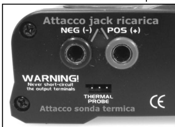
TRITON permette alla batteria di raggiungere in un range compreso tra 60-130° F (35-104 °C). Quando la batteria raggiunge questa temperatura prefissata il TRITON arresterà il processo di carica per salvaguardare la batteria. I valori suggeriti sono i seguenti : NiCd e NiMH : 125 °F; Li-Ion/Li-Po, Pb regolatela circa 10°F
